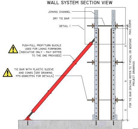
IMPORTANT INFORMATION JOINING CHANNELS CAN BE USED TO COMBINE WALL SYSTEM TOGETHER TO INCREASE POUR HEIGHT.
