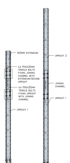
STEP I POSITION JOINING CHANNEL INSIDE 'UPRIGHT I' MAKING SURE THE JOINING CHANNEL CAN BE FIXED TO UPRIGHT USING 4x TENSILE BOLTS. STEP 2
