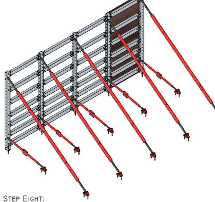
START FIXING THE PLYWOOD SECURING IT FROM BEHIND USING 25MM WOOD SCREWS. MAKE SURE THE PLYWOOD JOINTS FALL ON THE CENTRE OF THE UPRIGHTS OR THE HORIZONTAL JOINING MEMBERS.
